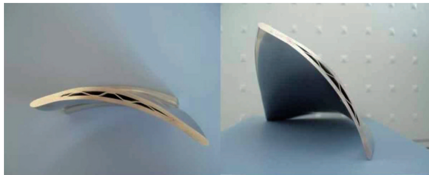
图2 宽弦风扇叶片剖切照片
