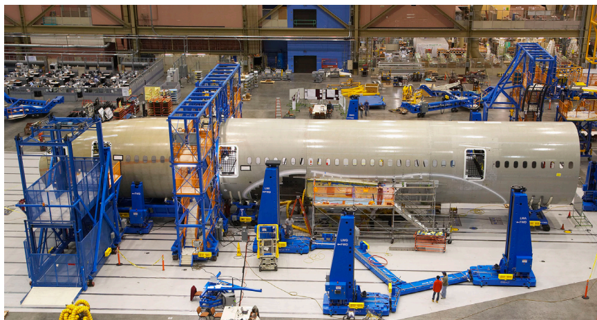
图3 波音787的机身段自动对接
