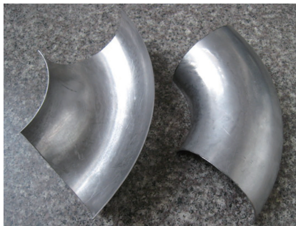
图4 \delta 1.5\text{mm} 导管焊接件形貌
