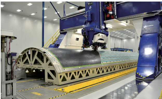
图2 Electroimpact 公司的铺丝机 Fig.2 AFP of Electroimpact
