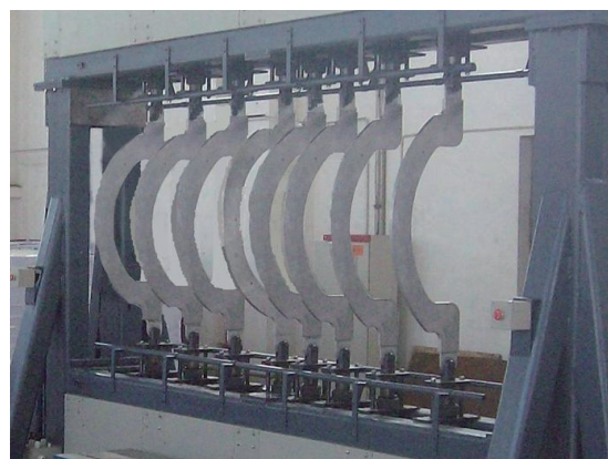
图6 飞机装配数控柔性多点工装
