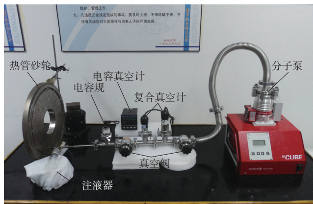
图4 热管砂轮制作平台
