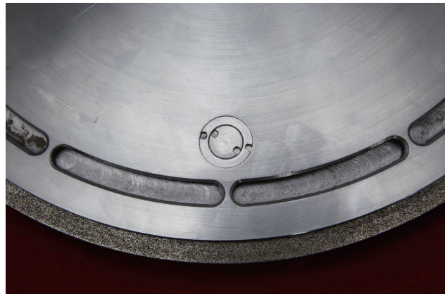
图6 热管砂轮的真空封尾
