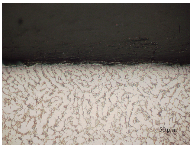
图9 热管砂轮磨削TC4的显微组织
