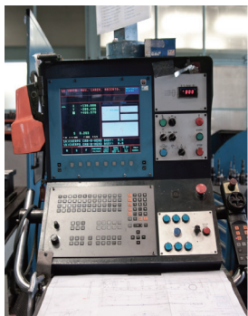
Inmapa利用iTNC 530的精准编程完成飞机的薄壁零件加工
