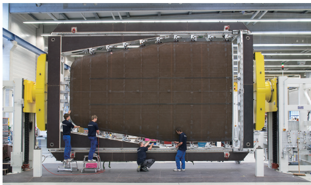
图10 VARI成形技术在A400M货舱门中的应用
