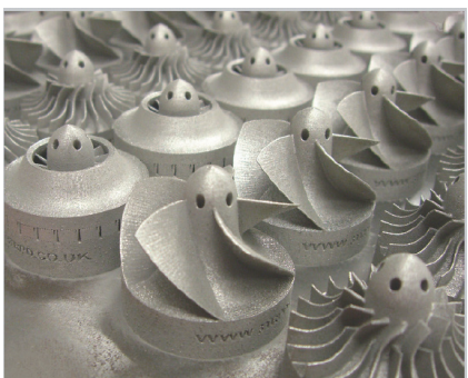
图8 激光选区熔化成形喷射发动机内压缩机叶片
