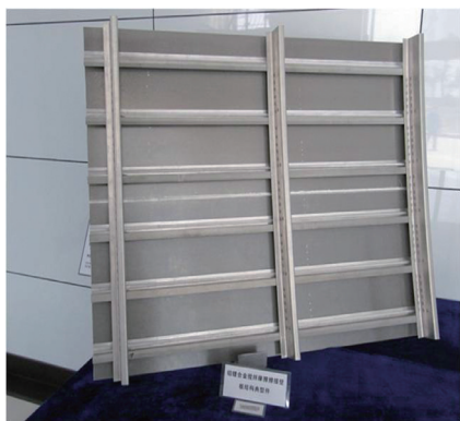
图3 铝铝合金激光焊接壁板试验件
