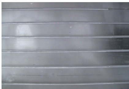
图3 平直对接搅拌摩擦焊制造的飞机带筋结构
