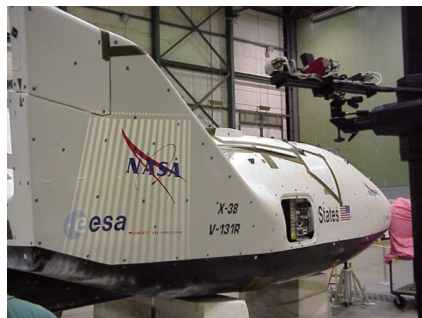
图2 X-38蜂窝结构方向舵
