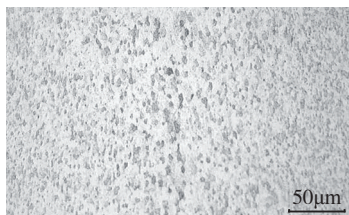
图5 细晶颗粒Fe 3 Al-ODS合金摩擦焊接头显微组织 [28]
