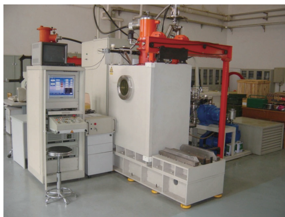
图6 国内首台电子束熔丝沉积成形设备
