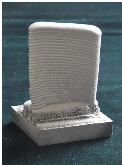
图7 激光直接沉积TC11钛合金叶片
