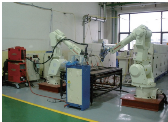
图1 双光束激光焊接设备及焊接过程
