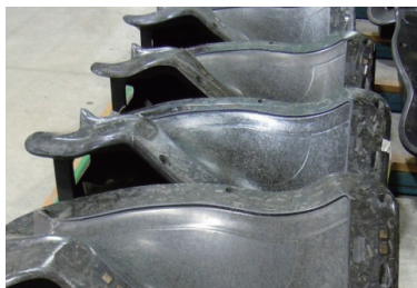
图6 风扇叶复合材料质成型模具 Fig.6 Composites press mold
