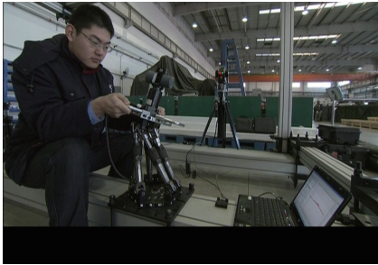
图3 激光跟踪仪6D测量装置应用
