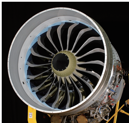
图5 LEAP-X发动机复合材料风扇叶片 Fig.5 Composites fan blades of LEAP-X
