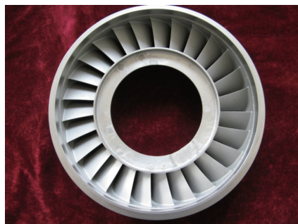
图1 修复后的高温合金涡轮导向器
