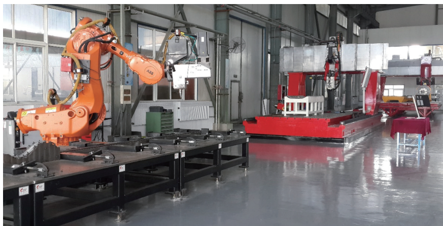
图1 具有国际先进水平的搅拌摩擦焊技术开发平台 (左1: 机器人搅拌摩擦焊系统; 中: 动龙门搅拌摩擦点焊设备; 右1: 高精度空间曲线搅拌摩擦焊设备)
