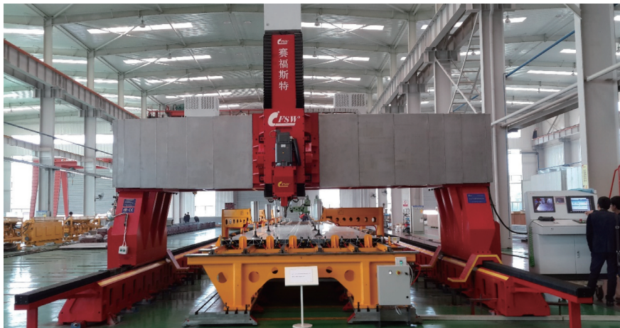
图4 26m长的列车地板搅拌摩擦焊设备
