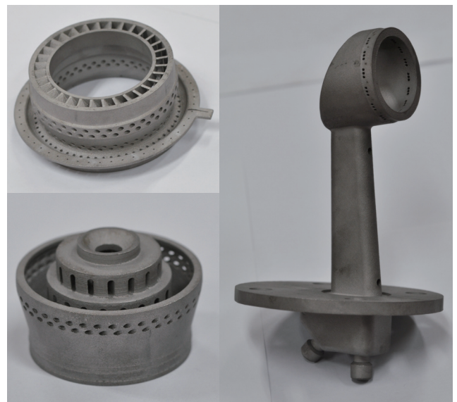
图5 利用增材制造成形的燃油喷嘴组件
