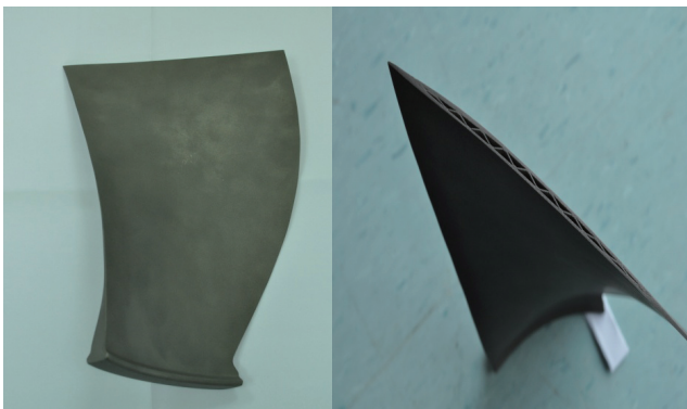
图6 增材制造的缩比钛合金空心风扇叶片
