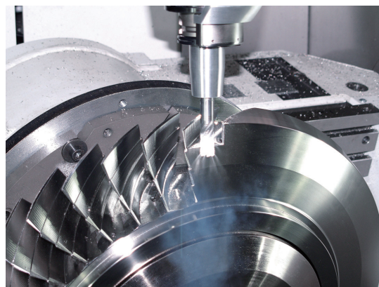
图2 整体叶盘插铣加工 Fig.2 Plunge milling of blisk
