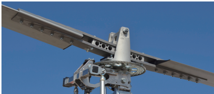
图1 旋翼桨叶根部处与旋翼毂连接方式示意图
