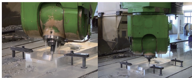
图15 系统替代后S件试切试验图
