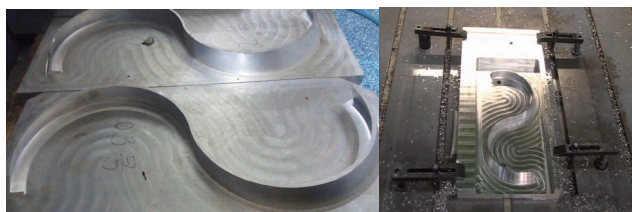
图16 试切试验加工的S试件
