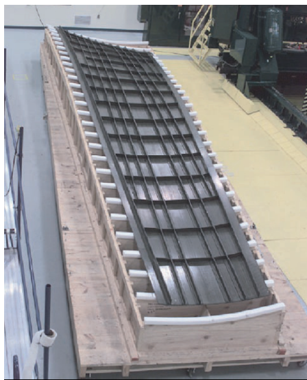
图1 AST计划中整体化的壁板组件
