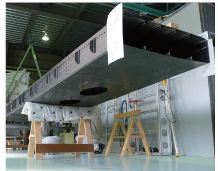
图2 JAXA研制的机翼盒段
