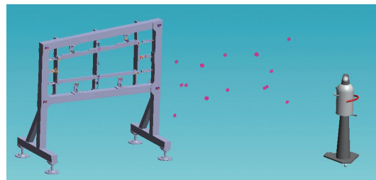
图1 基于激光跟踪测量设备安装型架
