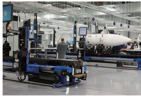
图2 雷锡恩公司柔性对接单元 Fig.2 Raytheon flexible assembly unit
