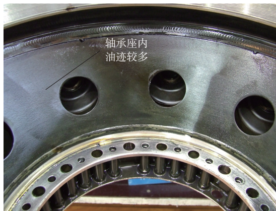
图1 高压止推轴承腔密封失效分解后故障现象
