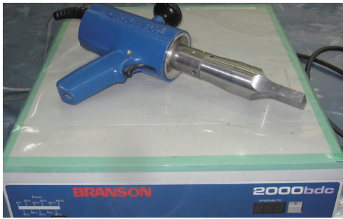
图2 超声波枪 Fig.2 Ultrasonic Z-pinning tool
