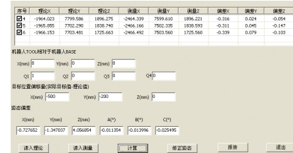
图3 机器人初次位姿调整后测量数据图
