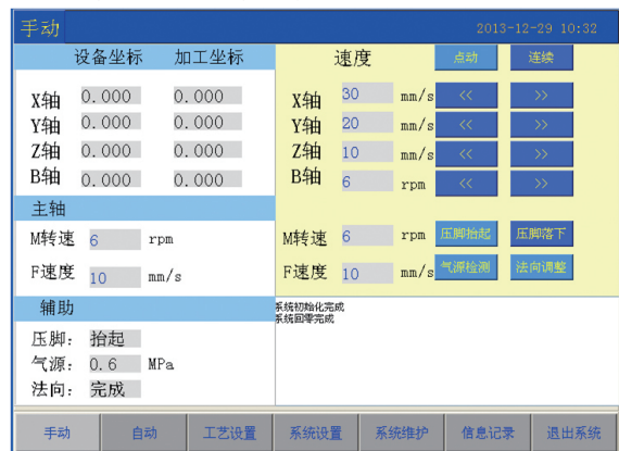
图3 爬行机器人制孔手动控制操作界面
