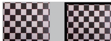
(a) 矫正前 (b) 矫正后 图4 矫正前后图像对比(红色的点为检测角点)
