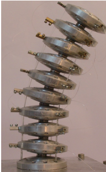
图1 DBD关节组成的蛇形臂机器人 Fig.1 DBD joints snake arm robot
