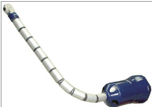
图2 OCRobotics研发的蛇形臂机器人 Fig.2 OCRobotics snake arm robot
