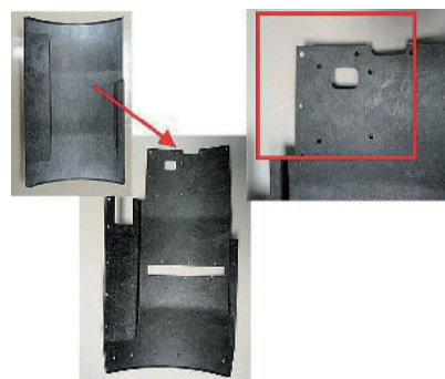
图3 碳纤维LFT成型复合材料中孔、切边及开槽口的可加工性能
