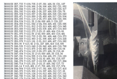
图5 程序代码截图及加工过程 Fig.5 Program code and machining process
