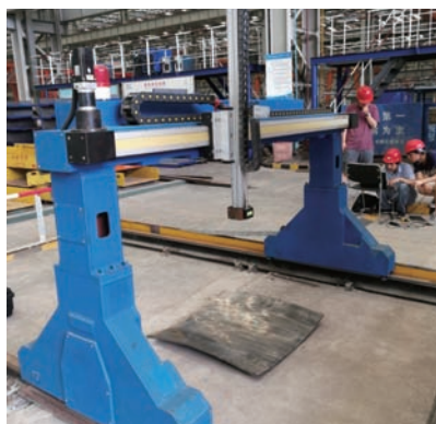
图3 基于激光位移传感器的点扫描随动测量装置
