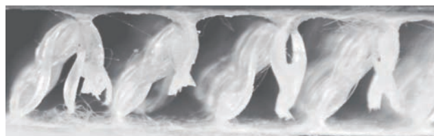
(a) 经向剪切工况下试件的破坏模式
