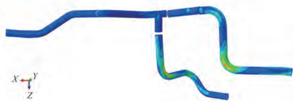
图12 ABAQUS整体分析Mises应力分布图
