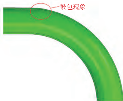
图6 芯棒伸出量为11mm时复合管发生鼓包
