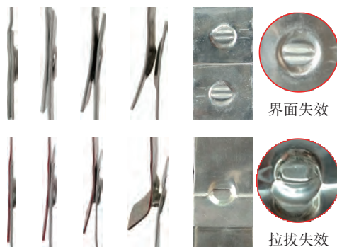
图7 磁脉冲点焊试件准静态剪切拉伸失效形式
