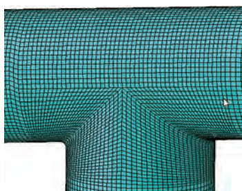
图10 区域B焊缝位置网格划分结果
