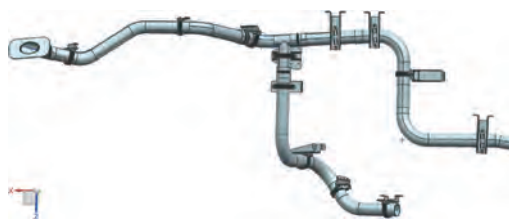
图3 管路系统三维模型
