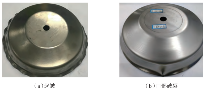
图1 镍基高温合金室温拉深旋压成形缺陷
