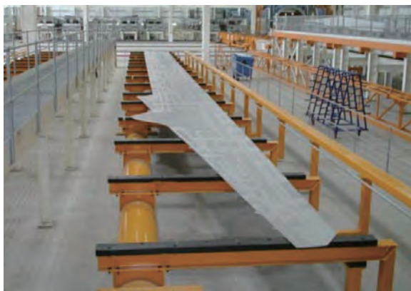
图7 利用蠕变时效工艺成形的A380机翼蒙皮件
