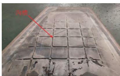
图4 蒙皮表面形成的沟槽
