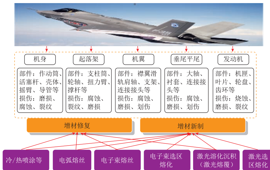
图2 不同部位零件损伤形式及维修工艺
