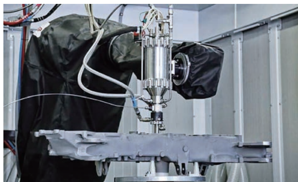
图 4 机器人辅助的冷喷涂技术应用用于飞机零件修复
