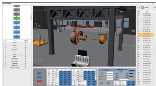
图10 单模块装配工艺流程仿真
