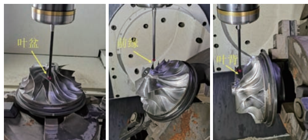
(a) 叶盆段测量 (b) 前缘段测量 (c) 叶背段测量
