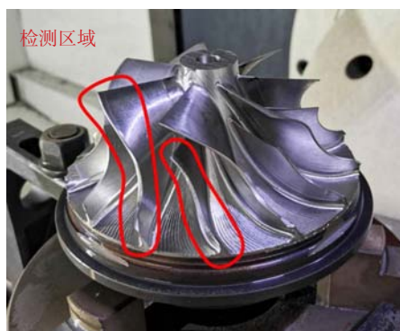
图 9 叶片检测区域 Fig.9 Blade detection area
