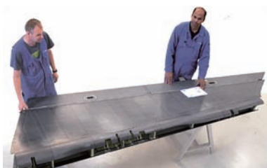
图4 Fokker公司研制的CF/PPS热塑性复合材料舵面
