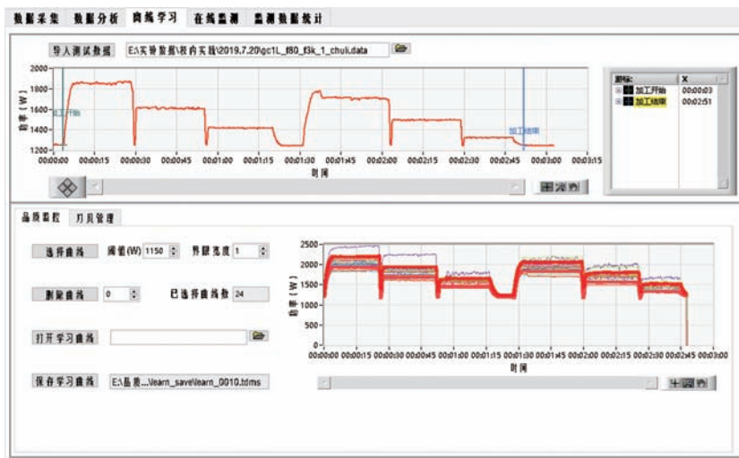
图4 基于功率信息的刀具监测软件系统
