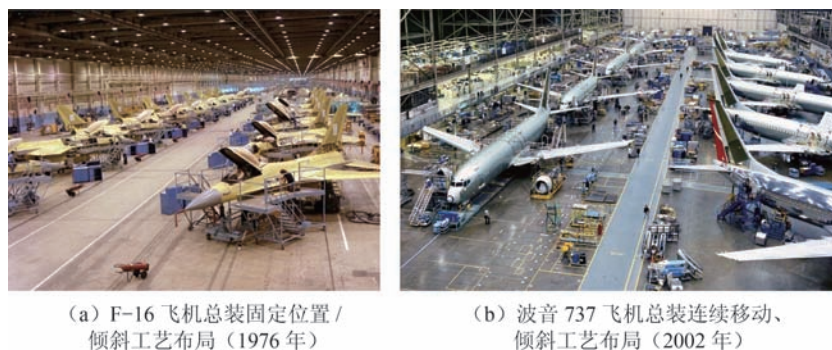
图1 飞机总装生产线典型工艺布局
