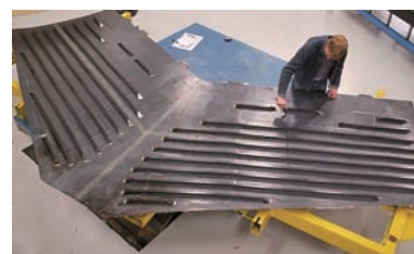
图15 Fokker公司制造的CF/PEKK热塑性复合材料飞机水平尾翼
