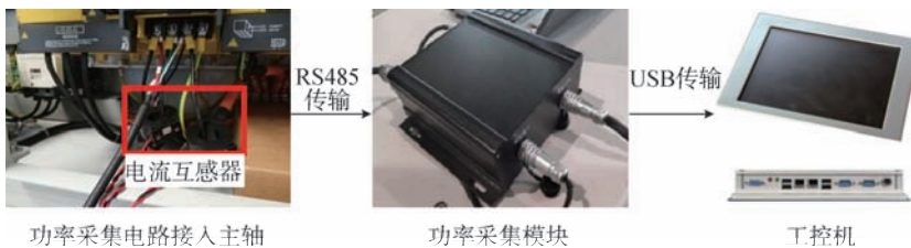
图3 基于功率信息的刀具监测硬件系统
