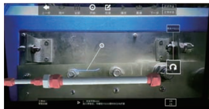
增强现实辅助管路装配引导场景
