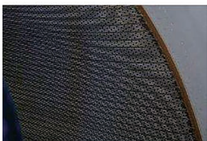
(b) 发动机短舱降噪声衬结构
