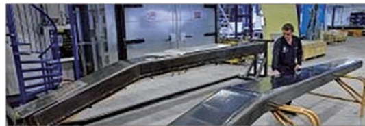
(b) 发动机短舱吊架热塑性复合材料上部梁零件
