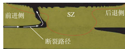
图9 转速1504 r/min、焊速207 mm/min、下压量0.12 mm参数下的接头断裂路径
