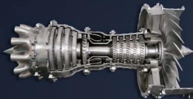
IN718航空发动机 860 \times 420 \times 480 \text{mm}^3
