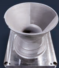
钛合金尾喷 \phi 394 \times 341 \text{mm}^3
