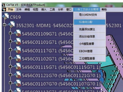
图 3 集成到 CATIA 软件中的标准件分配工具集
