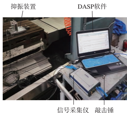
图7 模态锤击试验装置
