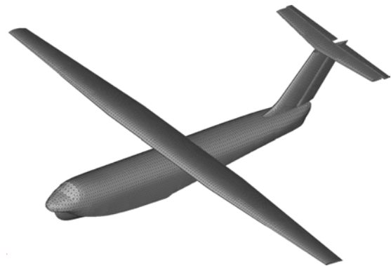
图7 飞机结构有限元模型
