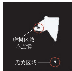
图 13 自适应阈值分割处理结果 Fig.13 Results of adaptive threshold segmentation
