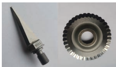
图 16 航空工业成都飞机工业(集团)有限责任公司超声加工刀具 Fig.16 Ultrasonic cutting tools of AVIC Chengdu Aircraft Industrial (Group) Co., Ltd.
