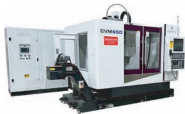
(a) 液氮内喷式超低温冷却加工机床 [25]
