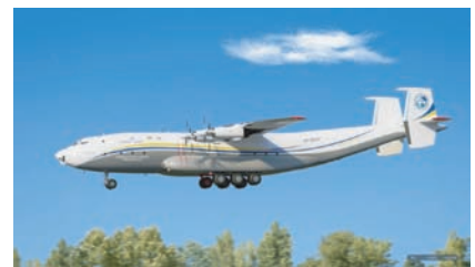
图 11 苏联 An-22 共轴对转桨扇推进运输机 Fig.11 Coaxial reverse rotating prop-fan An-22 airliner of USSR
