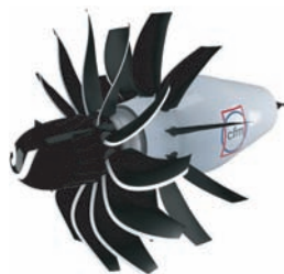
(a) CFM公司的试验型桨扇发动机
