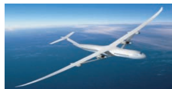
(b) 波音公司的支撑翼民航概念机
