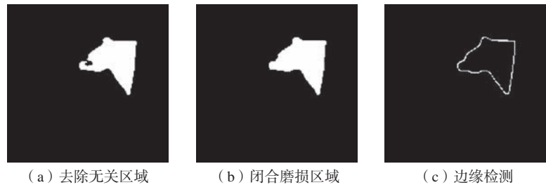
图15 磨损区域优化与边缘提取处理结果
