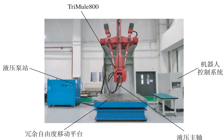
图10 六自由度混联机器人组成图
