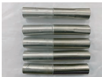
图 10 拉伸试样断裂位置
