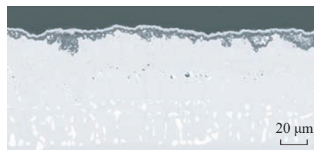
图 13 DZ125-5 μm-870 °C 渗铝试样 1150 °C 完全静态氧化 100 h 截面形貌
