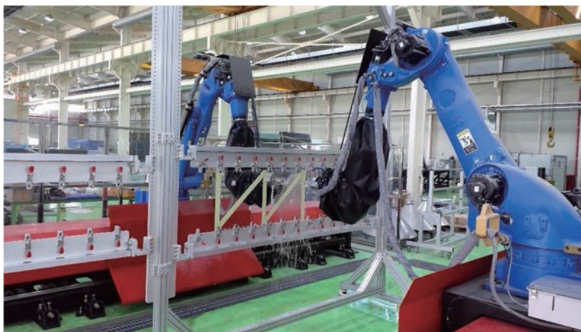
图 6 扫描具有人工缺陷的参考样本 [40]
