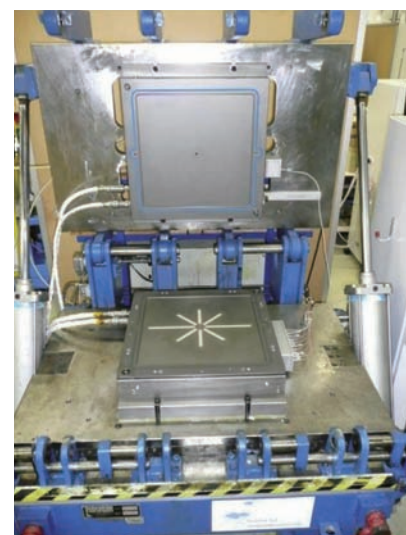
图7 二维平面渗透率测量单元,下模具安装有电容式传感器 [43]
