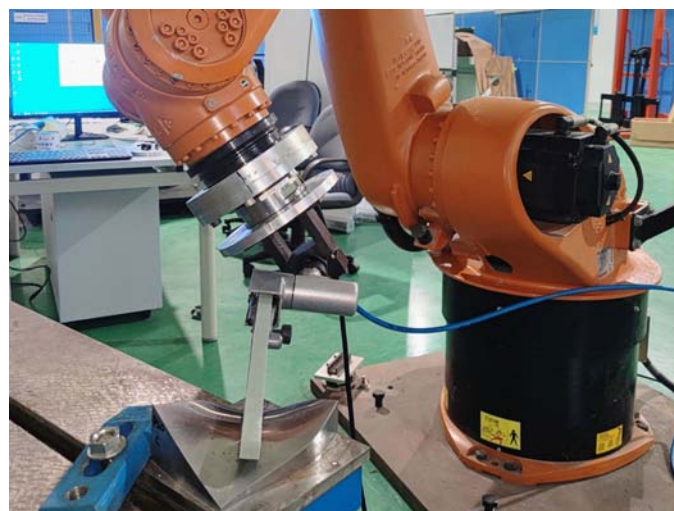
图7 机器人磨抛试验
