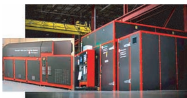
图 6 LSPT 公司开发的 Procudo200 型 LSP 系统 [37]
