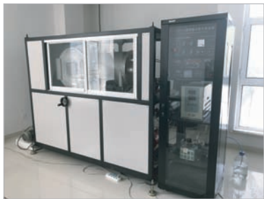
图 10 HOPE-I 型 HCPEB 装备 Fig.10 HOPE-I HCPEB system
