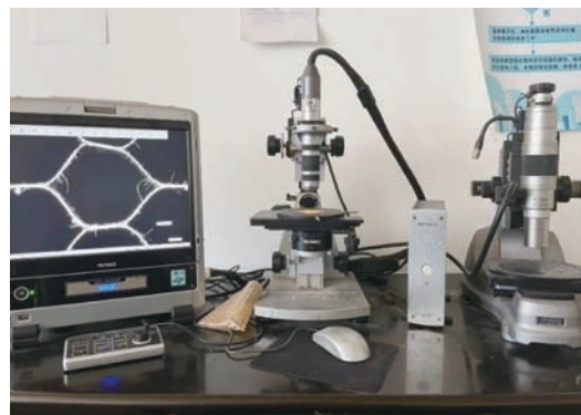
图4 利用超景深显微镜观测蜂窝材料加工表面
