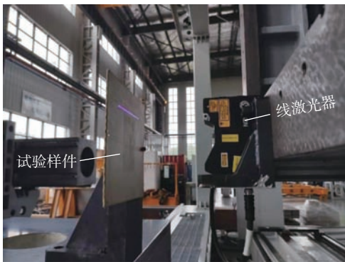
图 8 激光刻型在机精度检测试验平台
