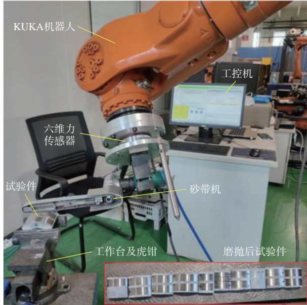
图 6 试验设备及磨抛后试验件
